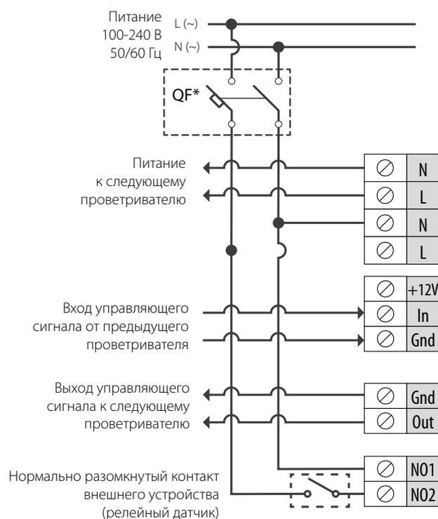
**СХЕМА ПОСЛЕДОВАТЕЛЬНОГО ПОДКЛЮЧЕНИЯ ПРОВЕТРИВАТЕЛЕЙ**
