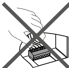
Для извлечения разъема используйте плоскую отвертку
