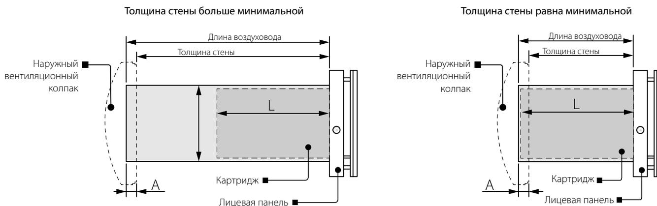
Длина воздуховода зависит от модели проветривателя (см. «Структура условного обозначения»).
