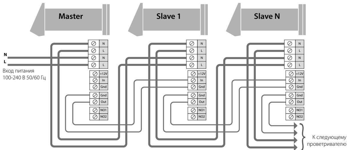
**СХЕМА ПОДКЛЮЧЕНИЯ ПРОВЕТРИВАТЕЛЕЙ С РАЗВЕТВЛЕНИЕМ**
