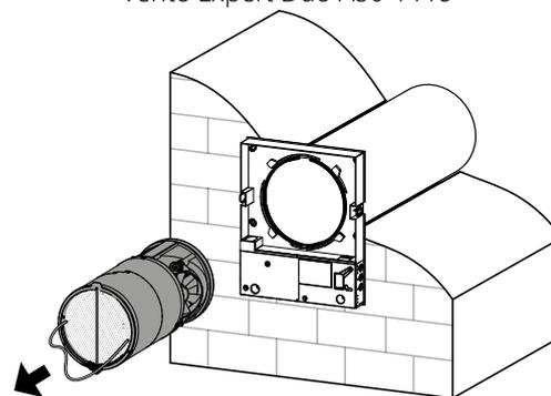
4. Вымойте фильтры и оставьте их на просушку до полного высыхания. Установите сухие фильтры на прежнее место и соберите установку в обратном порядке. Допускается очистка с помощью пылесоса.
