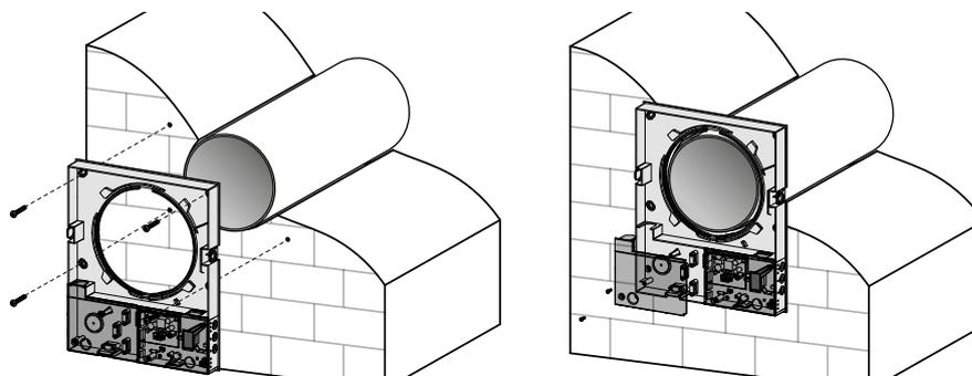
6. Заведите кабель питания, как показано на рисунке ниже, и выполните подключение проветривателя согласно схеме внешних подключений (см. стр. 12).
