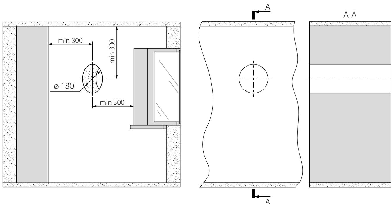
2. Установите воздуховод в стене и зафиксируйте его с помощью монтажной пены. С наружной стороны стены воздуховод должен выступать на расстояние, необходимое для установки наружного вентиляционного колпака (см. руководство к наружному вентиляционному колпаку).
