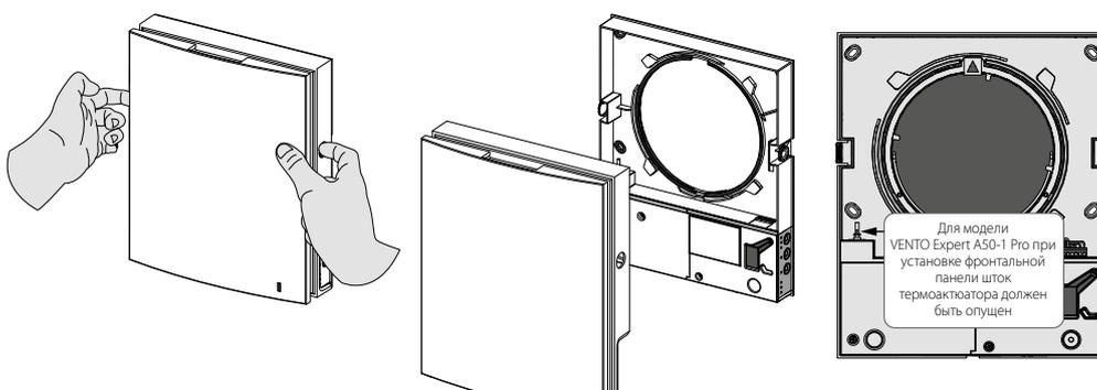
Для модели VENTO Expert A50-1 Pro при установке фронтальной панели шток термоактюатора должен быть опущен
