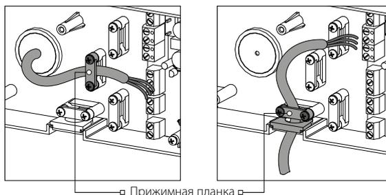
7. Установите картридж в воздуховод, как показано на рисунке ниже. Следите, чтобы метка указывала вверх. Затем подключите разъем к плате, закрепив провод выступающей скобой.
