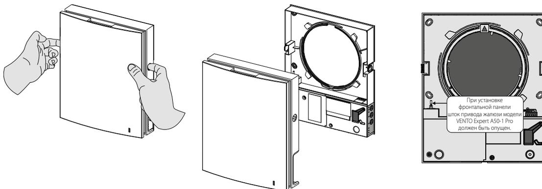
2. Извлеките разъем из платы управления. При извлечении разъема не тяните его за провода, при необходимости подденьте разъем плоской отверткой соответствующего размера.
