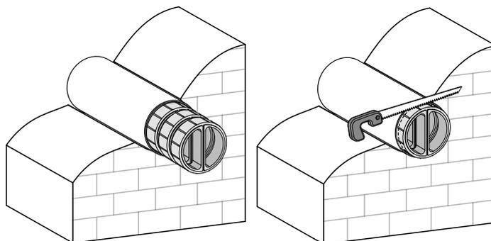
10. Установите наружный вентиляционный колпак. Монтаж наружного вентиляционного колпака описан в руководстве пользователя на вентиляционный колпак.
