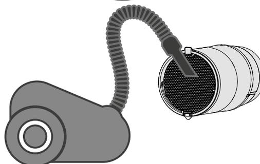
Для обнуления таймера фильтра перед тем как установить на место фронтальную часть комнатного блока подайте электропитание на проветриватель с помощью автоматического выключателя, после этого включите на период не менее 3-х секунд и выключите DIP-переключатель №8 (см. стр. 14).
