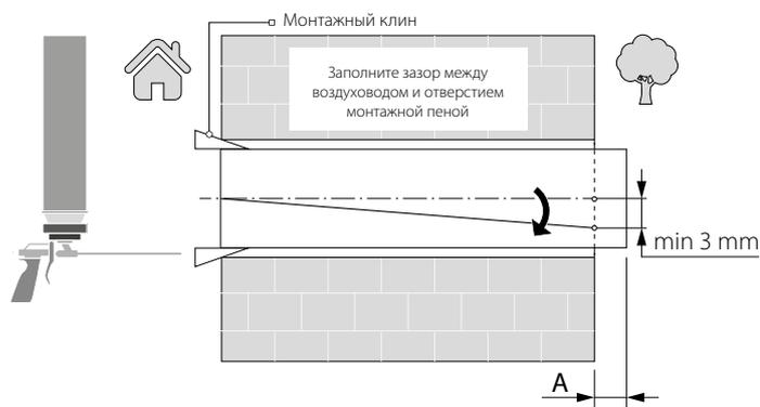
Установите воздуховод в стене таким образом, чтобы со стороны помещения он выступал на 3 мм или был вровень со стеной.
