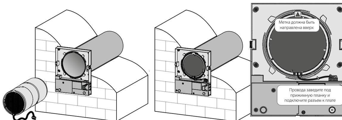
8. Установите фронтальную часть комнатного блока. При этом шток термоактюатора должен быть опущен, как показано на рисунке в п. 4 на стр. 10.
